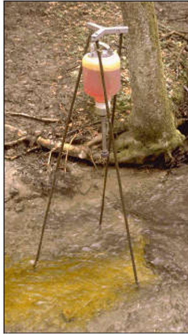
Figure 7 : jaugeage à débit constant
