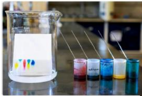
Expérience représentant la séparation des colorants sur une plaque CCM
