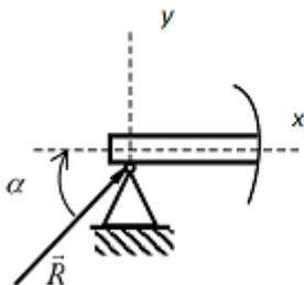
Figure 3.7 : (a) Un appui articulé.
