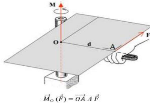
Figure 3.10 : Sens de rotation de levier par rapport au point O.
