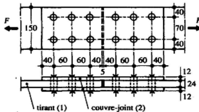
On demande de contrôler les boulons de l'assemblage en supposant que les sections cisillées passent par la tige des boulons.
