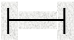
Profilé métallique enrobé de béton
