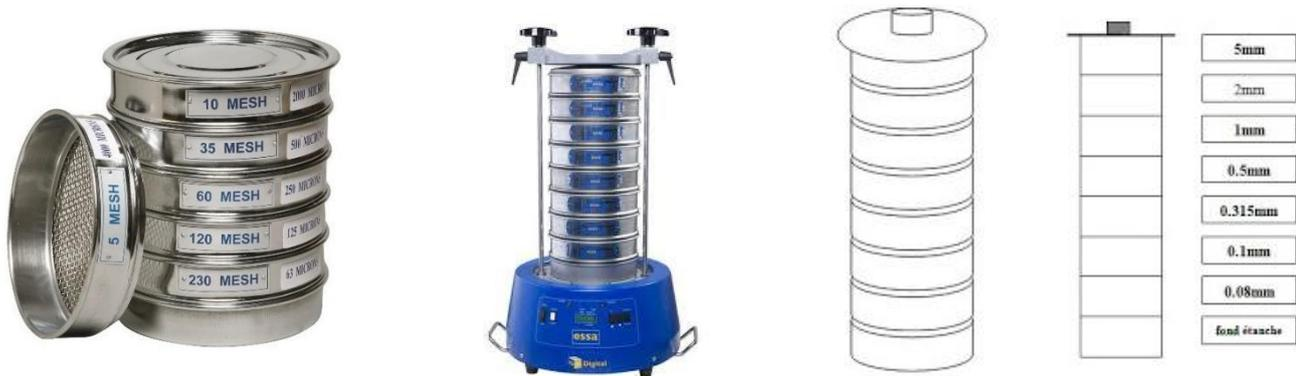
**Résultat de l'essai analyse granulométrique :** Après l'échantillonnage la masse de l'échantillon est  $M = 1\text{kg}$  Le résultat de l'analyse granulométrique est représenté sur le tableau suivant :
