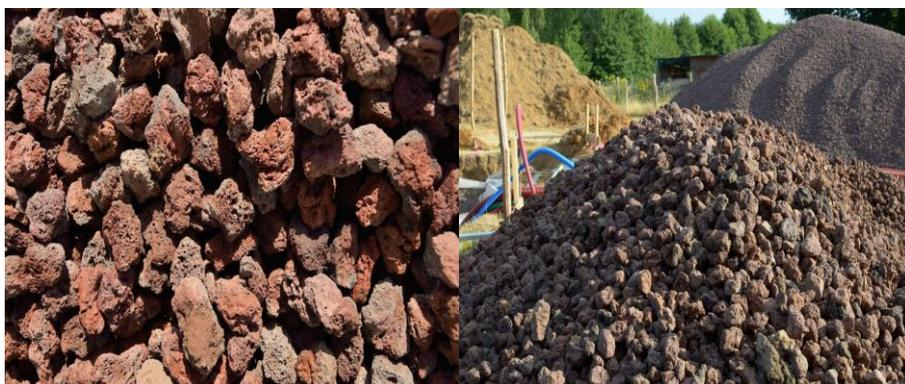
**Figure II.9.** La pouzzolane est utilisée comme liant dans la fabrication du ciment.
