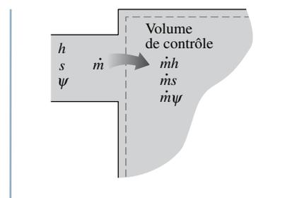
**FIGURE 8.28** La masse possède de l'énergie, de l'entropie et de l'exergie. Un écoulement entrant ou sortant d'un volume de contrôle est accompagné de transfert d'énergie, d'entropie et d'exergie.
