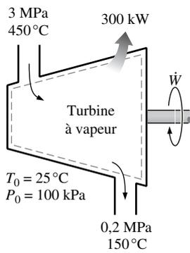
FIGURE 8.44 Schéma de l'exemple 8.15.
