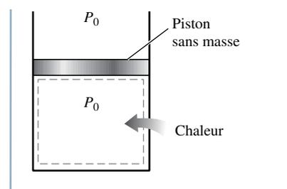
**FIGURE 8.27** Il n'y a pas de transfert de travail utile si la pression du système est la même que la pression du milieu extérieur.
