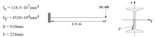
La poutre est sollicitée par une charge P = 50 kN appliquée à son extrémité libre. Calculer la variation de la contrainte pour une déviation de P de  $2^{\circ}$  par rapport à l'axe z-z.
