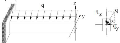
Pour une action simultanée de My et Mz, les contraintes en un point de coordonnées y et z se déterminent par la formule :
