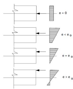
Le contour du noyau central de la section est déterminé par l'ensemble des positions des points d'application de la force excentrée qui fait passer l'axe par tous les points tangents à la section de telle manière qu'elle ne le coupe nulle part.
