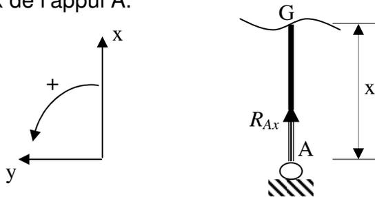
Ici on étudie la partie de gauche donc :  $\{\tau_i\} = - \begin{Bmatrix} \Sigma F / x & \Sigma M / x \\ \Sigma F / y & \Sigma M / y \\ \Sigma F / z & \Sigma M / z \end{Bmatrix}$
