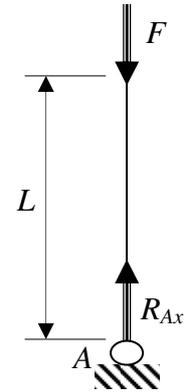
Calculons le torseur de cohésion dans une section quelconque G située à la distance x de l'appui A.
