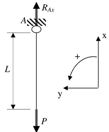
Calculons le torseur de cohésion dans une section quelconque G située à la distance x de l'appui A.
