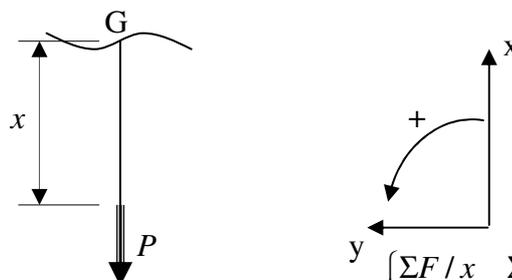
$$\text{Ici on étudie la partie de gauche donc : } \{\tau_i\} = - \begin{Bmatrix} \Sigma F / x & \Sigma M / x \\ \Sigma F / y & \Sigma M / y \\ \Sigma F / z & \Sigma M / z \end{Bmatrix}$$
