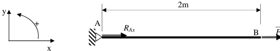
Le principe fondamental de la statique nous permet aisément de calculer la réaction  $R_{Ax}$  :  $\sum F/x = 0 \rightarrow R_{Ax} + F = 0 \rightarrow R_{Ax} = -F = -8000\text{N}$  (le signe - veut dire que le sens de  $R_{Ax}$  est opposé à celui choisit)
