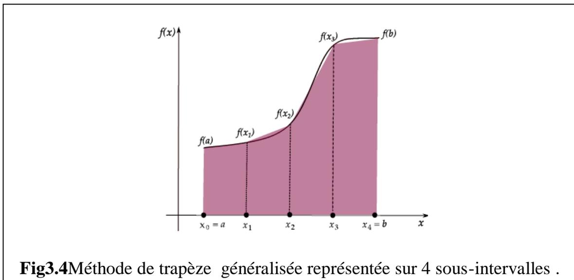
**Fig3.4** Méthode de trapèze généralisée représentée sur 4 sous-intervalles .
