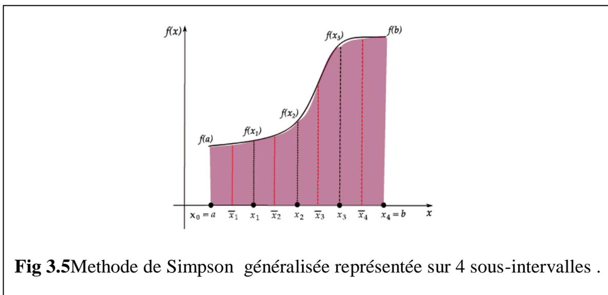
**Fig 3.5** Méthode de Simpson généralisée représentée sur 4 sous-intervalles .
