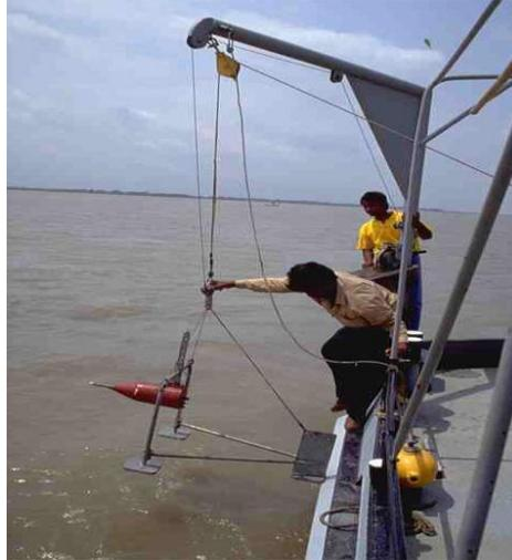
*Fig. IV.7 : Bouteille de Delft sur chariot*
