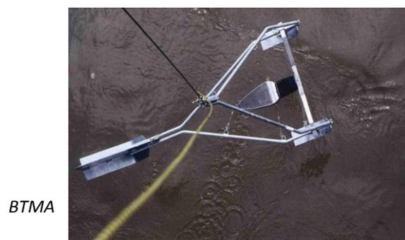
Figure IV.4 : Echantillonneurs : BTMA et Karolyi.
