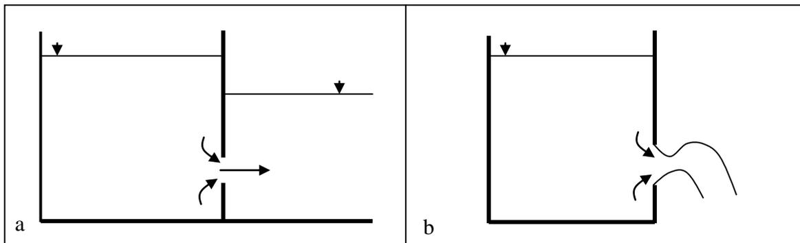
Fig. (IV.1) : (a) : orifice noyé, (b): orifice non noyé.
