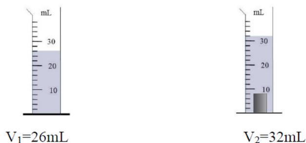
Figure II. 13 : Mesure du volume d'un solide par déplacement d'eau.
