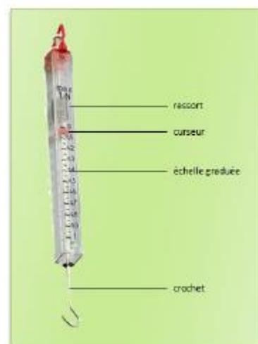
**Figure II.4 :** Schéma de principe de mesure de force par un dynamomètre.
