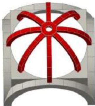
Figure 4. Coupole à nervures rayonnantes.
