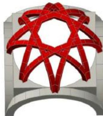
Figure 5. Coupole à nervures entrecroisées.
