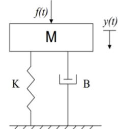
**Figure 2 : Schéma d'une suspension**
