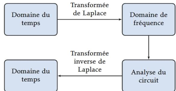
FIGURE 4 – Étapes d'analyse d'un circuit avec la transformée de Laplace
