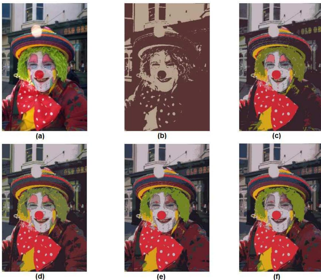
FIG. 7.5: Illustration de la méthode K-means. (a) Image originale. (b)-(f) Résultat de la segmentation de l'image en (a) avec la méthode K-means avec le nombre de classes  $K = 2, 8, 11, 14$  et  $15$ , respectivement.
