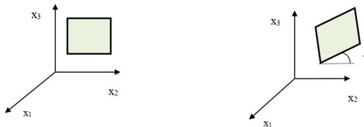
**Figure 2.** Exemple de déformation angulaire (distorsion)
