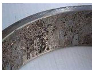
Écaillage d'une bague extérieure d'un roulement suite à un matage
