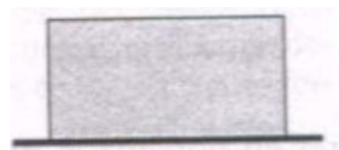
Mur en béton ou béton armé
