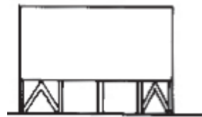
Éviter l'effet de niveau souple par des triangulations.
