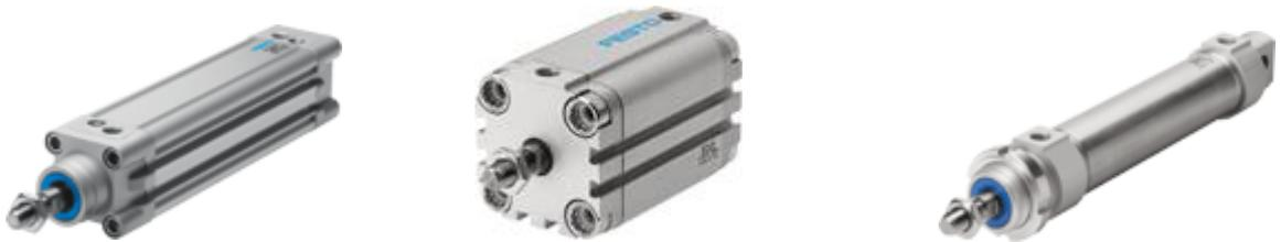
Les vérins réalisent des mouvements linéaires. Ils sont munis d'un piston avec une tige qui se déplace librement à l'intérieur d'un tube. En fonction du type ils ont un ou deux orifices permettant l'admission ou l'échappement de l'air. La longueur du mouvement définit la course du vérin, le diamètre est lié à la force à exécuter au cours du mouvement.
