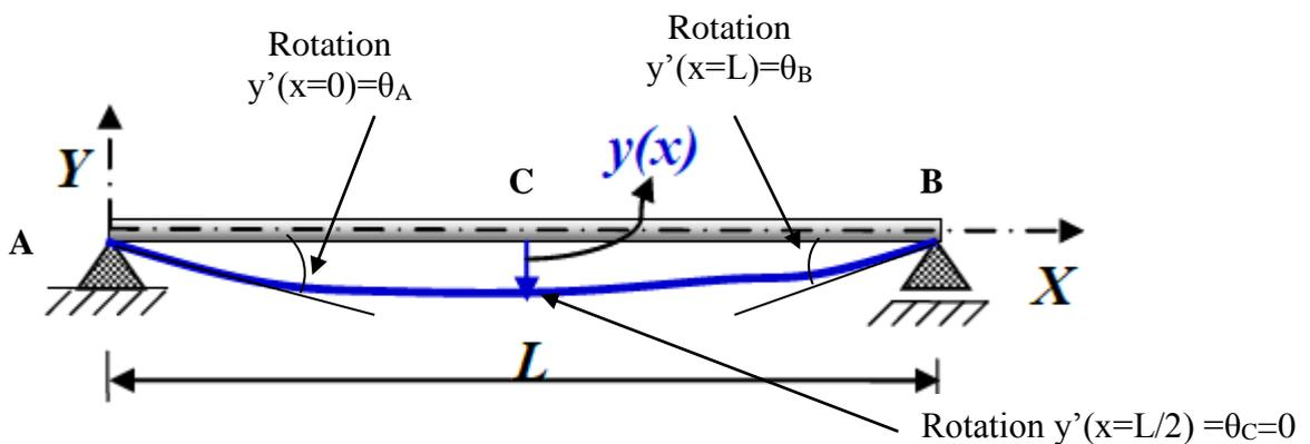
**Figure (V.6):** Poutre déformée
