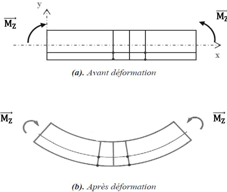
Figure (V.1): Représentation d'une poutre sollicitée en flexion
