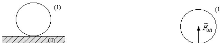
**Fig. 2.4-** Schématisation d'une charge concentrée.
