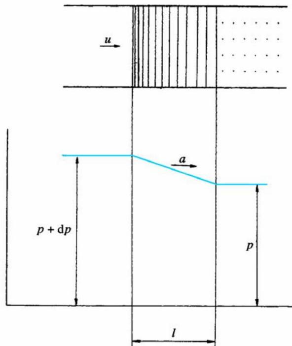
Fig. I-2 : Propagation de l'onde de compression.
