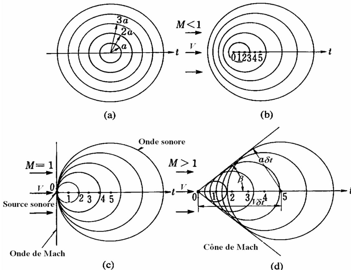
Fig. I-3 : Nombre de Mach et les propagations des ondes sonores : (a) repos ; (b) subsonique ( $M < 1$ ) ; (c) sonique ( $M = 1$ ) ; (d) supersonique ( $M > 1$ ).
