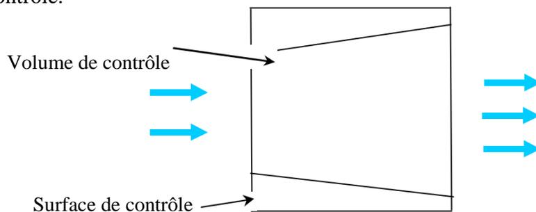
Fig. I-1 : Volume de contrôle.
