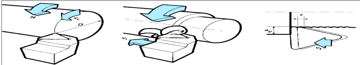
Figure II.7 Représentation des paramètres de coupe en tournage.
