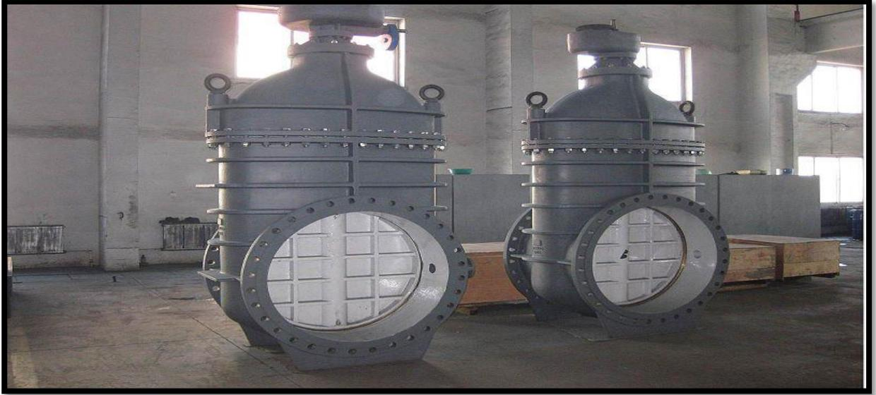
**Figure 20 :** Vanne opercule de grand diamètre
