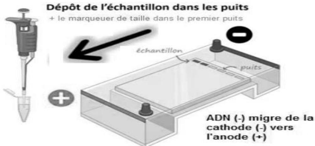
Après avoir terminé la préparation de la plaque électrophorétique, fermer la cuve et appliquer le champ électrique. Laisser migrer jusqu'à ce que le colorant de charge arrive à proximité du bord du gel (5 à 10 V par cm de gel).
