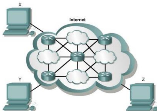
Le réseau Internet repose sur le modèle TCP/IP qui a été développé en vue d'avoir un réseau pouvant résister à toutes les situations (les données doivent être transmises quel que soit l'état d'un nœud/réseau). Depuis son développement, le modèle TCP/IP s'est imposé comme la norme Internet.
