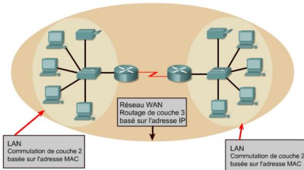
La commutation est une fonctionnalité de la couche 2 du modèle OSI et le routage de la couche 3. Un commutateur ne travaille qu'en couche 2 par contre un routeur en couche 2 et 3, donc, un routeur route et commute.
