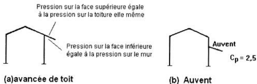
Figure 5.10 : C_p pour (a) avancée de toit (b) auvent ne faisant pas continuité avec la toiture
