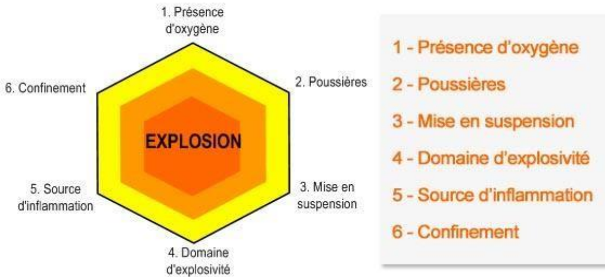
Fig.III.3. l'hexagone de l'explosion
