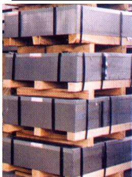
Ces tôles sont fabriquées à partir de tôles laminées à froid ou à chaud. Une couche de zinc est déposée sur la surface des de tôles, soit par immersion dans le zinc en fusion pour les tôles galvanisées, soit par électrolyse pour les tôles électro-zinguées, offrant ainsi une bonne protection contre la corrosion.
