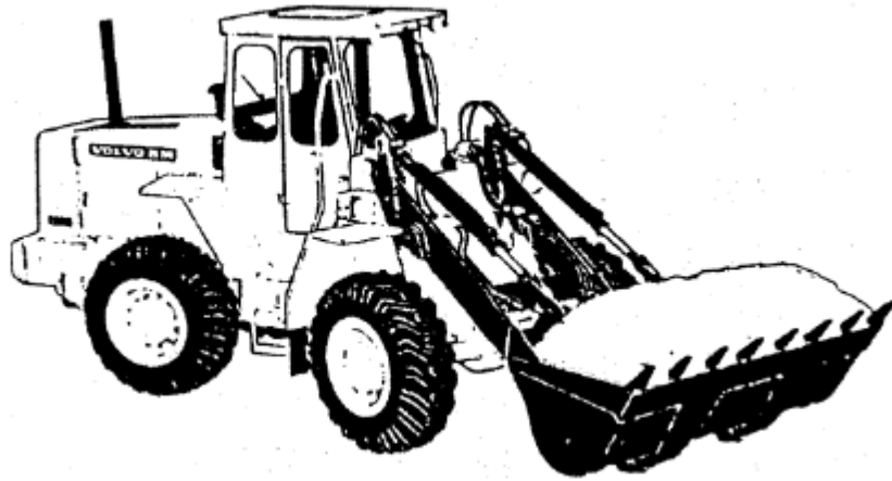
Figure II.24. Pelleteuse sur Pneumatique
