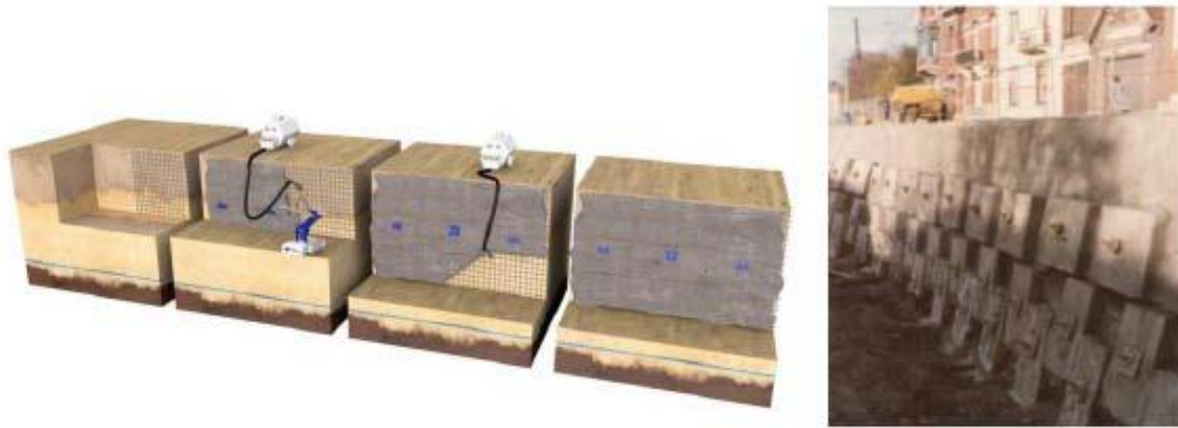
Figure II.12. Illustrations de parois cloutées
