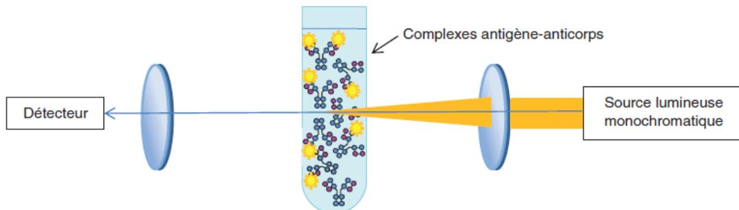
**Figure 2: Principe de la Turbidimétrie.**
