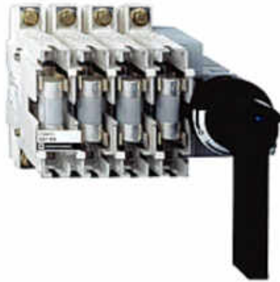
Figure 4.9 Interrupteur-Sectionneur porte-fusibles tétrapolaire 750V-125A avec levier de commande, Ref Schneider GSI-K4
