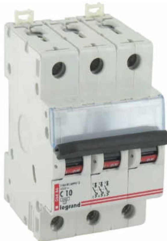
Figure 4.45 : Disjoncteur magnéto-thermique type C Legrand Tripolaire 400 V coupure 6000 A Intensité 10 A
