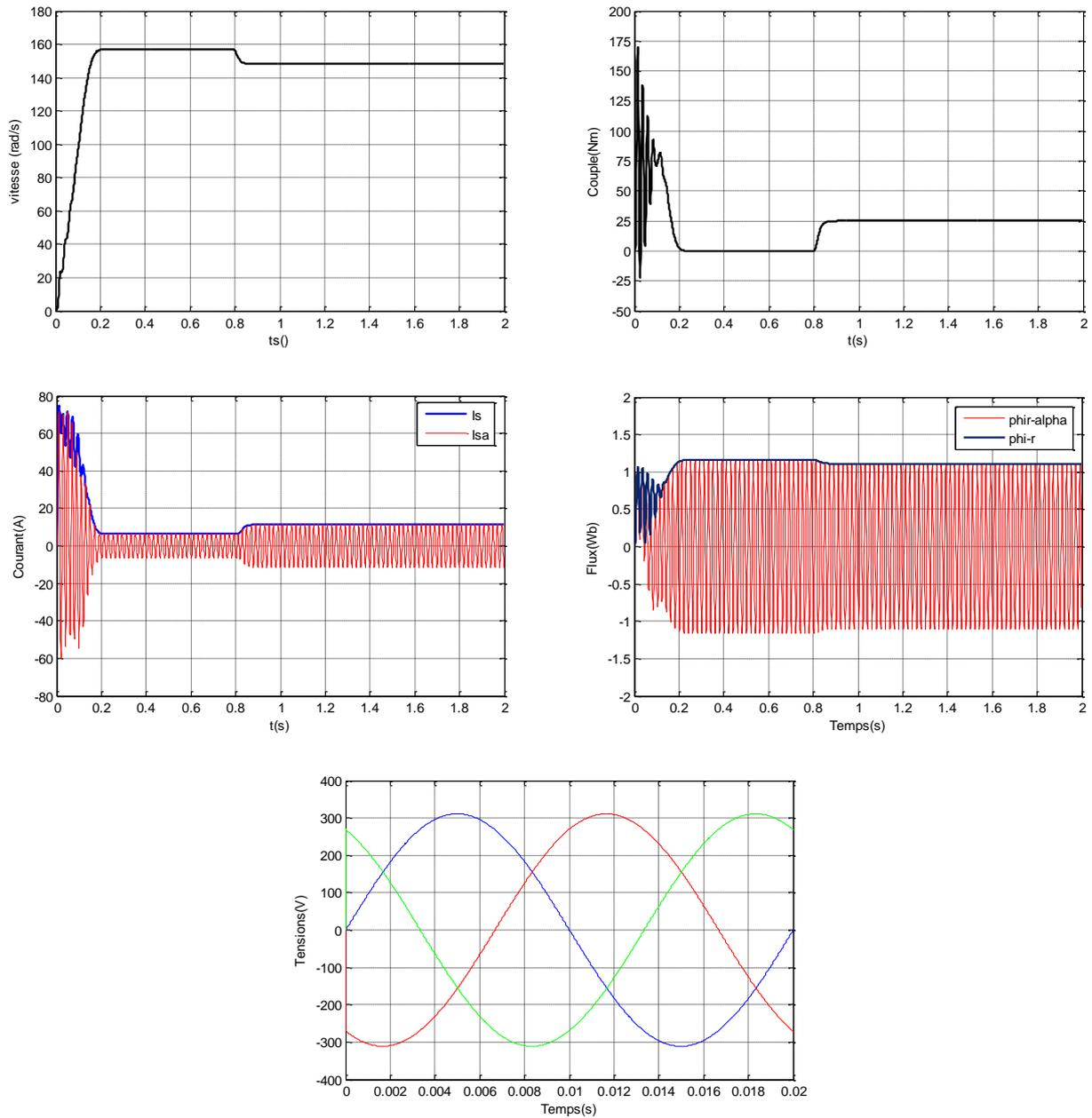
**Figure (I.5)** Résultat de simulation de la MAS, démarrage à vide suivi de l'introduction du couple de charge.
