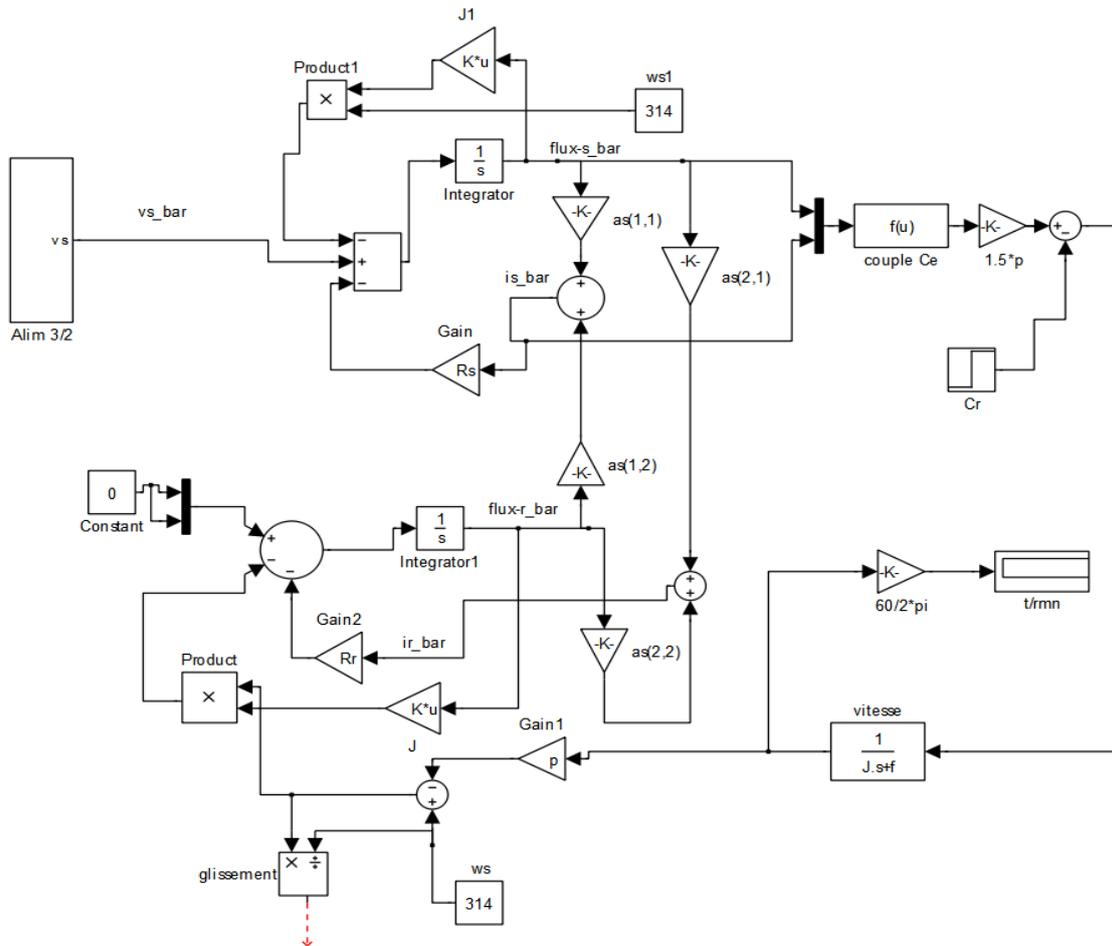
Figure (I.4) : modèle vectorielle de la MAS sous SIMULINK/MATLAB
