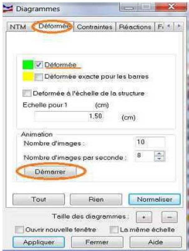
Pour afficher la déformée de la structure on clique sur l'icône **Déplacements** qui se trouve sur l'extrémité droite en bas de la fenêtre
