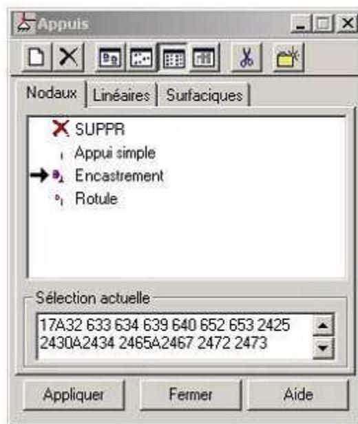
Il faut vérifier que pour le type d'appuis (encastrement) tous les déplacements et les rotations sont bloqués.
