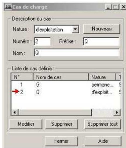
Le poids propre sera pris en compte avec la charge permanente G. Pour les charges sismiques, elles seront générées automatiquement par le logiciel. Les autres charges (vent, neige) seront négligées.
