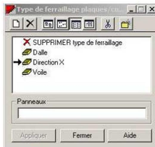
De la même manière que pour les épaisseurs, on doit définir deux types de ferrailage (un pour les dalles pleines et escalier et un autre pour les voiles). Sélectionner le type (voile) et fermer.
