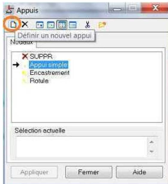
Par la boîte de dialogue **Définition d'appui** on peut définir les direction à bloquer en cochant les cases des déplacements suivant les axes comme illustré sur la figure quel soit des déplacements linéaires (UX, UY, UZ ) ou angulaires ( RX, RY, RZ ).
