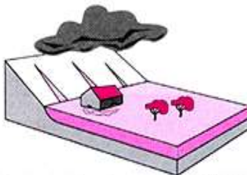
Figure 3 : Inondation par stagnation d'eau pluviale
