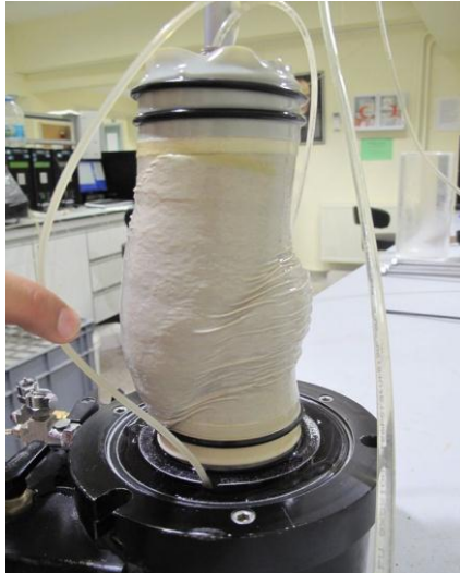
Figure 9 : Rupture d'un échantillon de sable après l'essai triaxial.
