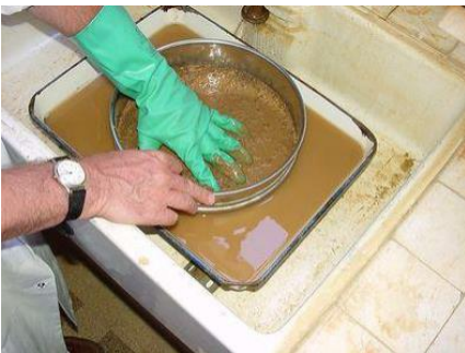
Tamisage de l'échantillon Voie Humide
