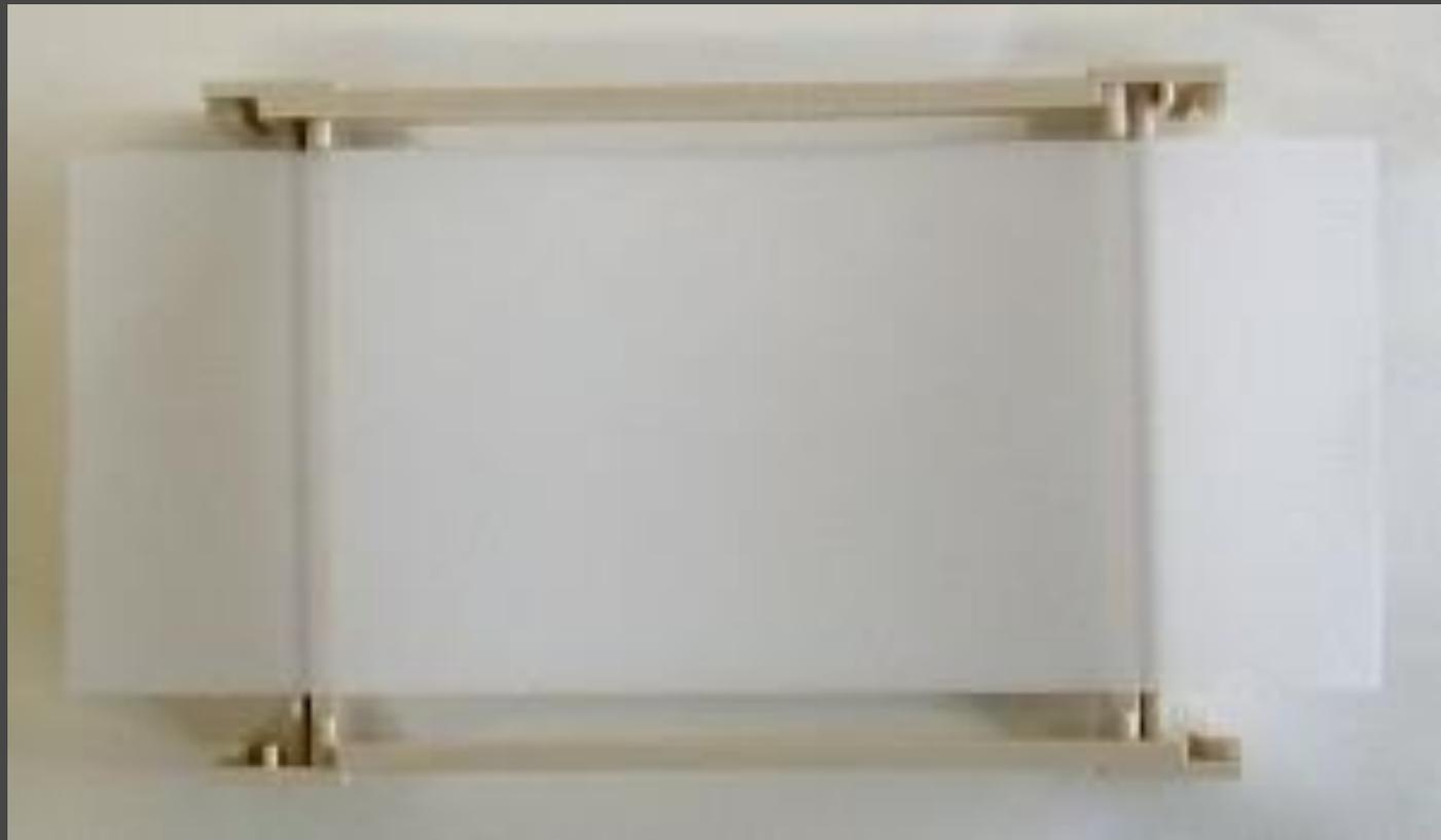
**Remplir les deux compartiments de la cuve avec un même volume de tampon d'électrophorèse. Mettre en place le(s) support(s) dans la cuve.**
