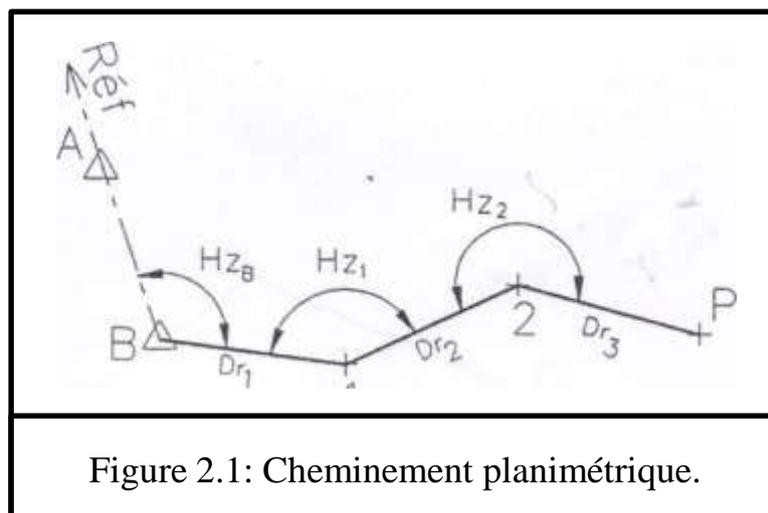
Le calcul consiste en une suite de rayonnements: on calcule les coordonnées du point 1 à partir de celles de B, puis celles de 2 à partir du point 1, et ainsi de suite jusqu'au point P, c'est-à-dire :
