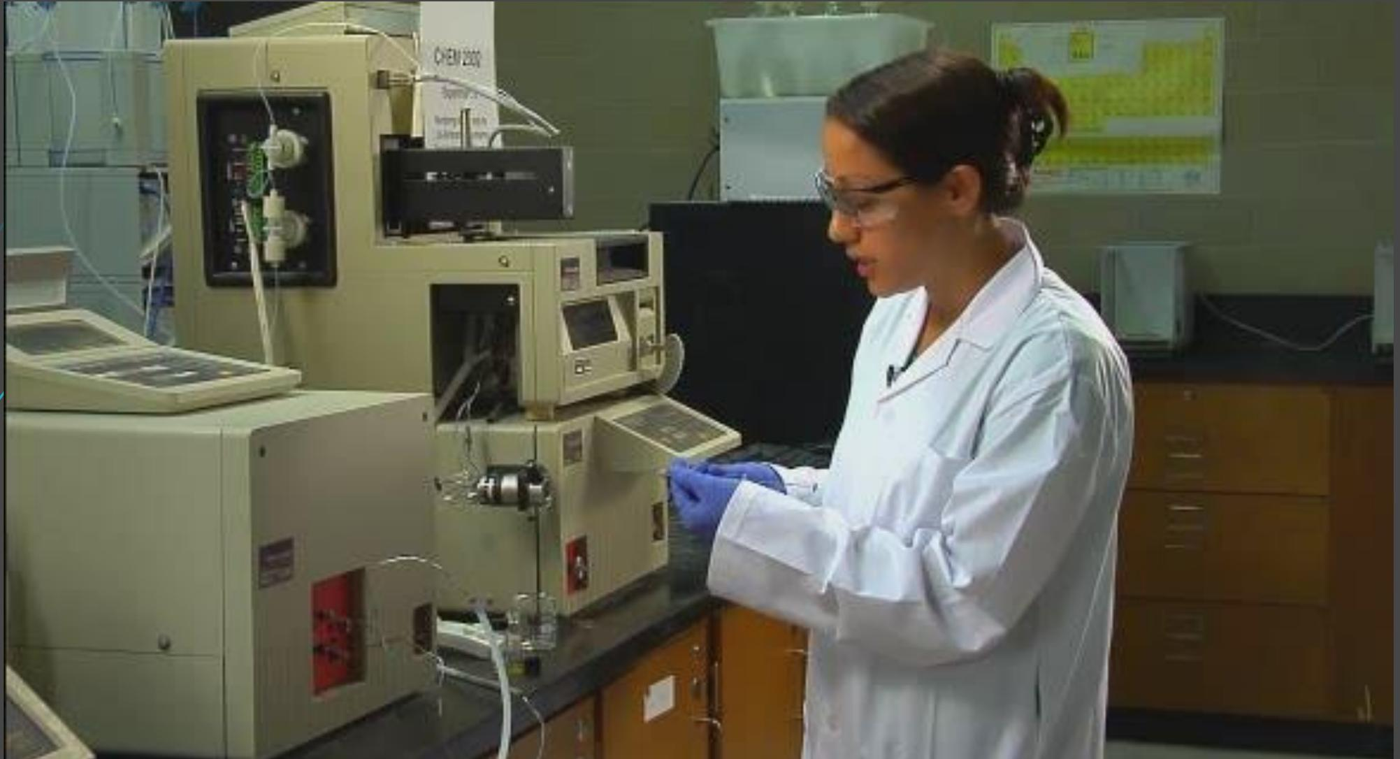
L'échantillon est introduit avec une seringue à la pression atmosphérique dans la boucle (position remplissage ou load (a))
