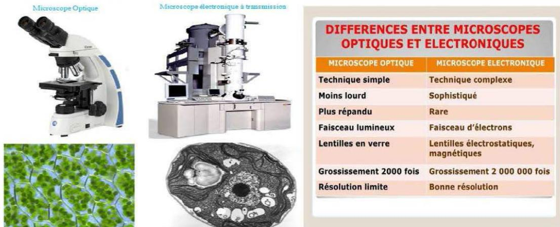
Figure 1 : Le microscope optique MO et le microscope électronique ME.
