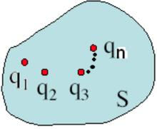
**نص نظرية GAUSS : تدفق الحقل الكهربائي عبر سطح مغلق s يساوي المجموع الحبري للشحن الموجودة داخل هذا السطح.**
