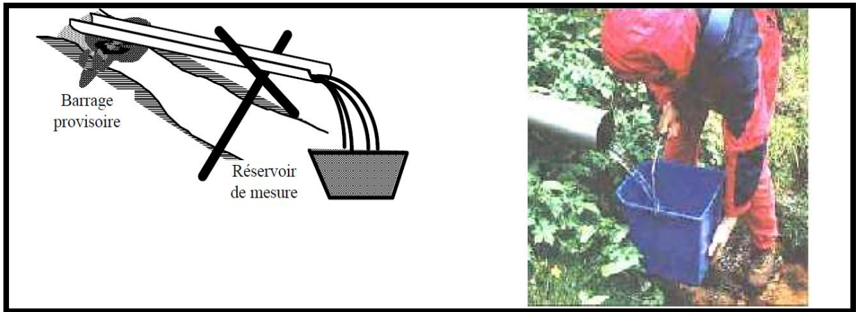
Figure 33 : Méthode de jaugeages par réservoir étalonné
