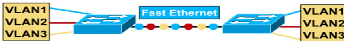
Les commutateurs sont un des éléments de base des communications VLAN. Chaque commutateur est en mesure de prendre les décisions relatives au filtrage et à l'acheminement par trame, en fonction des paramètres VLAN. Le commutateur peut aussi communiquer ces informations à d'autres commutateurs et routeurs du réseau.
