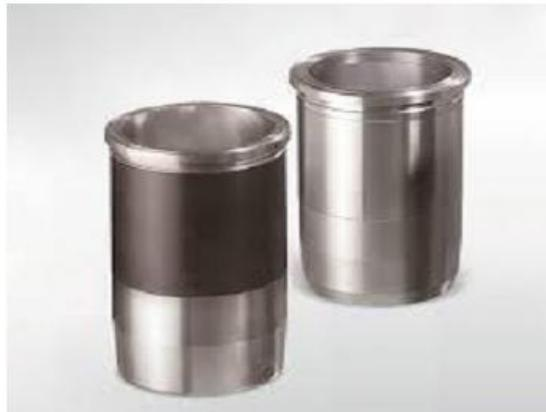
La chemise est une pièce cylindrique emmanchée en force dans le cylindre (ayant un métal plus résistant que le reste du bloc moteur), et dans laquelle coulisser le piston et où se produit la combustion/compression (fortes contraintes !).
