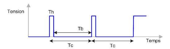
**Application** : vous utiliserez ce module chaque fois que vous aurez besoin d'un signal de fréquence fixe, exemple : pilotage d'un servomoteur, variation de vitesse d'un moteur à courant continu
