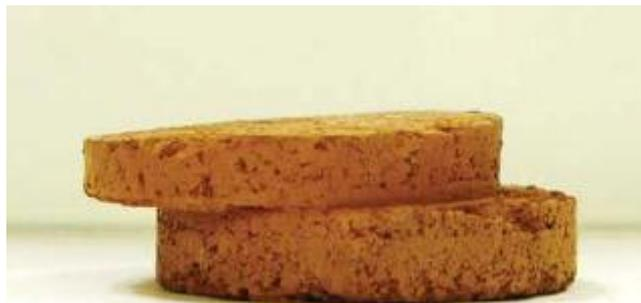
**Figure 9 :** L'échantillon après un essai de cisaillement direct.
