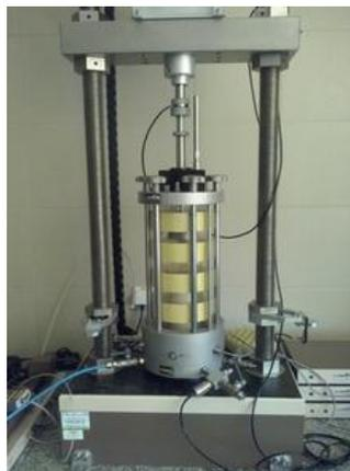
**Figure 11 :** Cellule triaxiale en place
