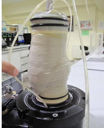
**Figure 14 :** Rupture d'un échantillon de sable après l'essai triaxial.
