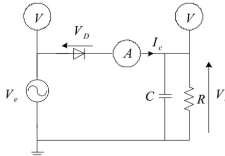
$C = 1\mu F, 10\mu F, 50\mu F, 100\mu F$ , et  $R$  fixé à  $100\Omega$
